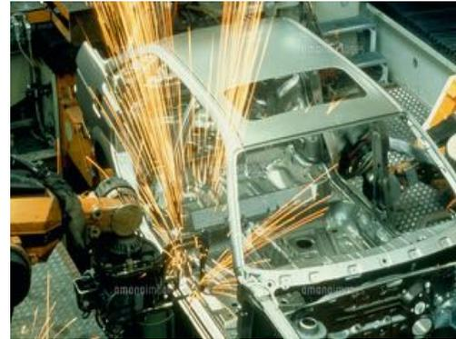
レーザー溶接加工
