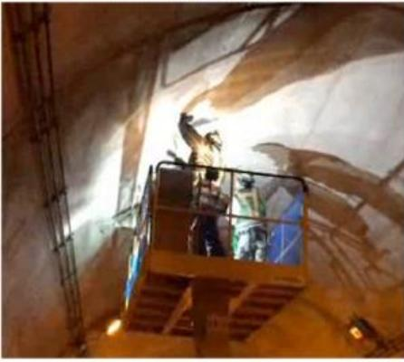
レーザー打音検査
