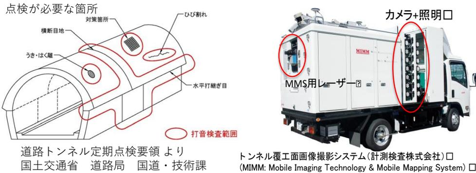
4. レーザー打音により、覆工面内部の欠陥を判定.
