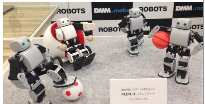
併せて、人感センサー、カメラ、ユーザ認識プログラムを内蔵する事で、「**人の行動を真似る**」ミラー機能(特許出願中)を保有する。
