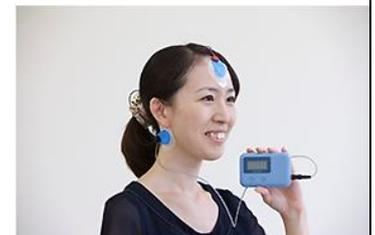
図2、新規開発の小型脳波計と装着の様子
