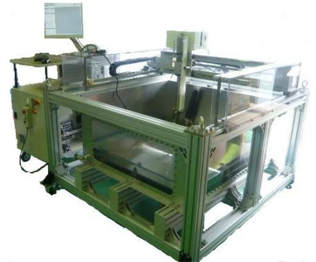
フェイズドアレイ超音波探傷装置
