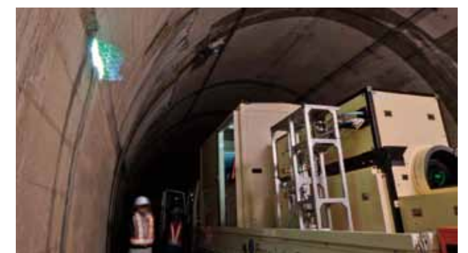
遠隔・非接触で短時間にコンクリート内部の欠陥を検知できるレーザー打音技術
