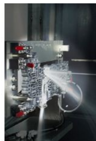
高圧水噴射状況
