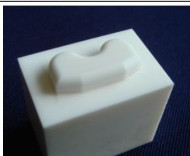
高純度焼結アルミナ(HRC77)金型直彫り
