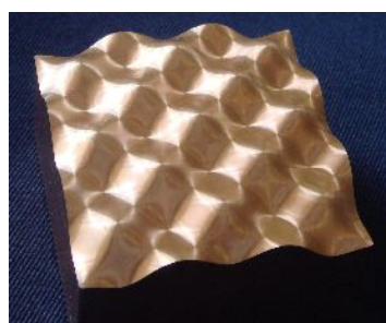
銅(Cu)ウェーブレンズの高品位加工
