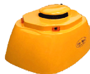
路面標示作図ロボット 「ヒューナビ」
