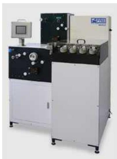
30ミクロン以下の超極細線領域で、新たな伸線加工技術の確立を目的に開発。1ダンサ、1ダイス、1キャプスタンを1つの伸線ユニットとして複数配置。キャプスタンを直接駆動させ、従来のスリップ型では困難だった極細金属線の製造を容易に（写真はユニット部の拡大）
