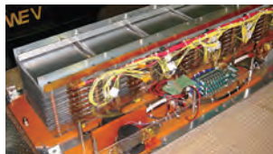
非接触給電式EV車 ちょビット充電車に積んだセル(80枚)
