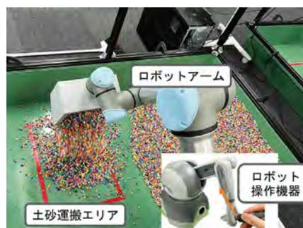
(図3) 模倣学習された土砂運搬作業
