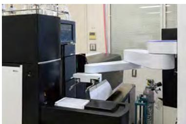
自律型実験システム (Autonomous Lab) のロボット対応LC
