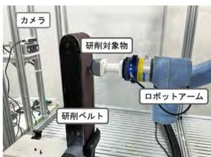
(図1) AI研削ロボット外観
