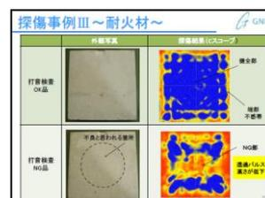
アルミハニカムパネルの時と同様に、配色を3色グラデーションと2色単色で表示したときの違いを示しています。2色の方が、損傷の判別がやりやすくなると思います。ただ、中央部は内在亀裂ですが、その他の端の部位でも検知しています。耐火材はアルミナやセラミックスを混ぜ込んだ建材ですので、その密度の不均一性や異常成長した結晶の有無、小さな剥離の可能性もあると思われます。【スライド24】
