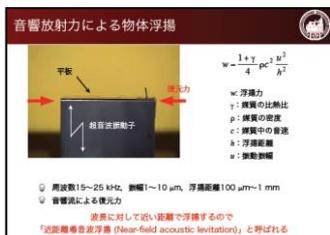
ある企業さんと共同開発した一軸のリニアステージの上にステーターが乗っていて、位置決めができるというものです。これは、4つの圧電材料が取り付けられていて、全体はセラミックできています。そこに図のような振動（1ミクロン程度）を与えると、超音波の放射力によりスライダが鉛直報告に100ミクロンほど浮きます。浮き上がりのイメージとしては「エア・ホッケー」の遊技機のような感じになり、完全に非接触となります。こうすると、接触型では発生する粉塵とかは心配がなくなります。このスライダには、5kg程度の物は乗せることができます。【スライド11】
