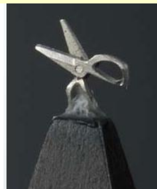
2009年切削加工ドリームコンテスト 銅賞受賞、(チタン製) 米粒より小さいマイクロ鉗
