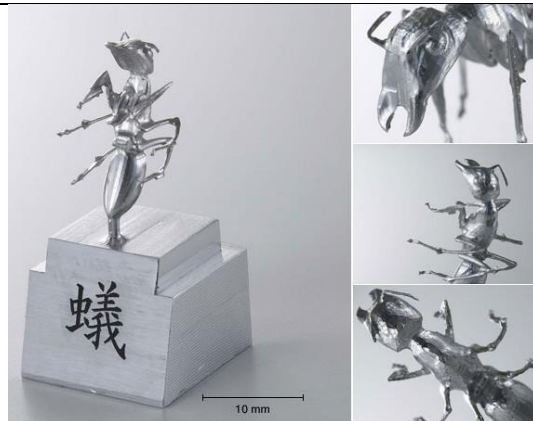
2008年ドリームコンテスト銀賞作品「蟻」 （材質：アルミ合金）触角径0.1mm、
