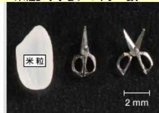
ワイヤ放電加工による SUS440C、硬度HRC58
