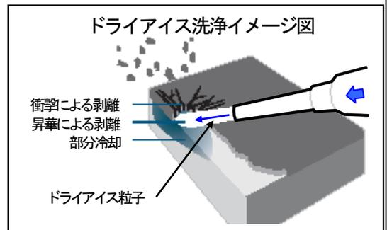
「ドライアイス生成装置」は、液化CO<sub>2</sub>を微小孔から放出し、断熱膨張させ、吐出側に設置したホーンによる圧力制御により、**洗浄に最適な径・硬度のドライアイス噴流を生成する。**
