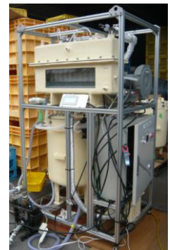
(超音波振動子：20個) 温泉水濃縮装置
