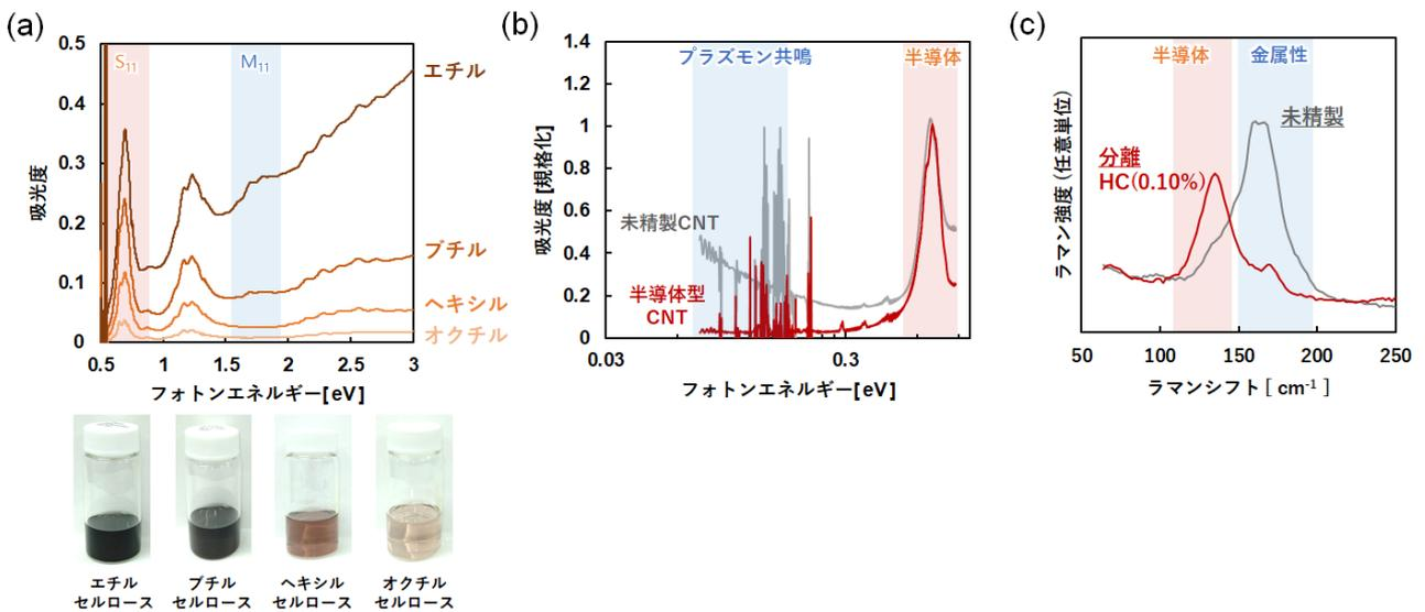
図 2. (a) 異なる側鎖長のアルキル化セルロースを用いた分散液の紫外可視近赤外吸収スペクトル (ポリマー濃度 0.25w/v% の乾燥テトラヒドロフラン溶液, 光路長 2 mm). (b) ヘキシルセルロース(HC)と分散ポリマー F127 を用いて分散した CNT 膜の赤外吸収スペクトル. (c) HC と F127 を用いて分散した CNT 複合膜のラマンスペクトル (励起波長 660 nm). F127 による分散では半導体型・金属型の選択性が見られない.
