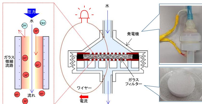
微細ガラスフィルターを用いた振動環境発電機のコンセプト
