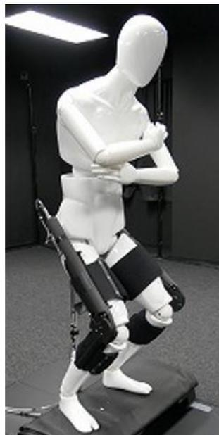
開発した装着型アシストロボット（黒の部分）を両足に装着したマネキン
