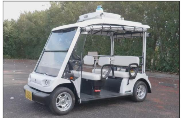
自動運転車両には自動運転開発開発向け車両を利用。自動運転 OS は、自動車メーカーの自動運転車両でも利用されている Autoware
