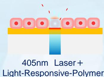
光応答性ポリマーの光熱変換による高速かつ選択的細胞除去
